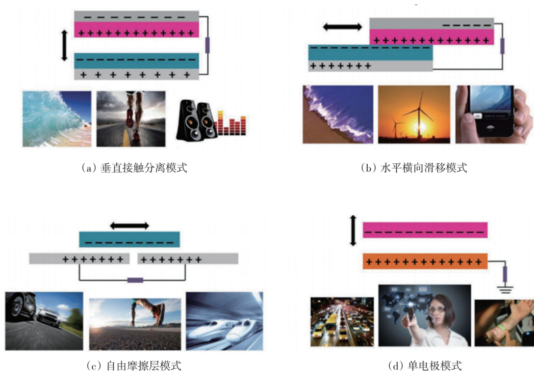
图5 摩擦纳米发电机4种工作模式
